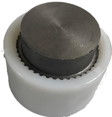
Pompa ve elektrik motoru arasındaki kaplin bağlantısı
